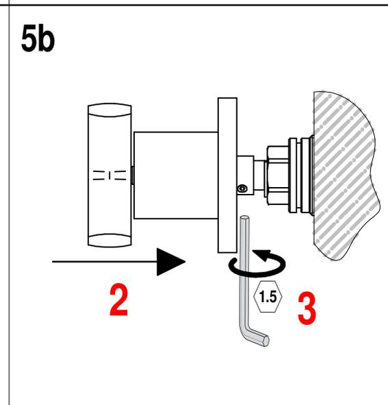
**SOSTITUZIONE VITONE / VALVE REPLACEMENT**
